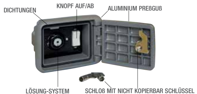
ACJ9078 STONE PANZERGEHÄUSE unter Putz (Spezielles Schloss) IP 54 mit 1 Hebelschalter und Elektrobremse Freischalte 142x106x80
