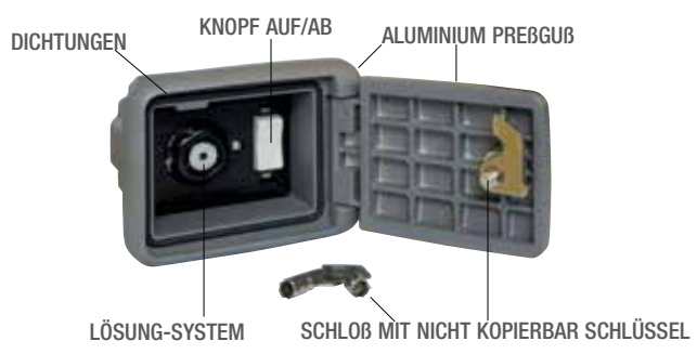
ACJ9078 STONE PANZERGEHÄUSE unter Putz (Spezielles Schloss) IP 54 mit 1 Hebelschalter und Elektrobremse Freischalte 142x106x80
